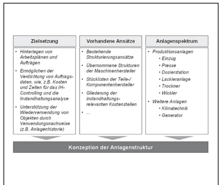
Bild 2 Randbedingungen für die Konzeption der Anlagenstruktur
